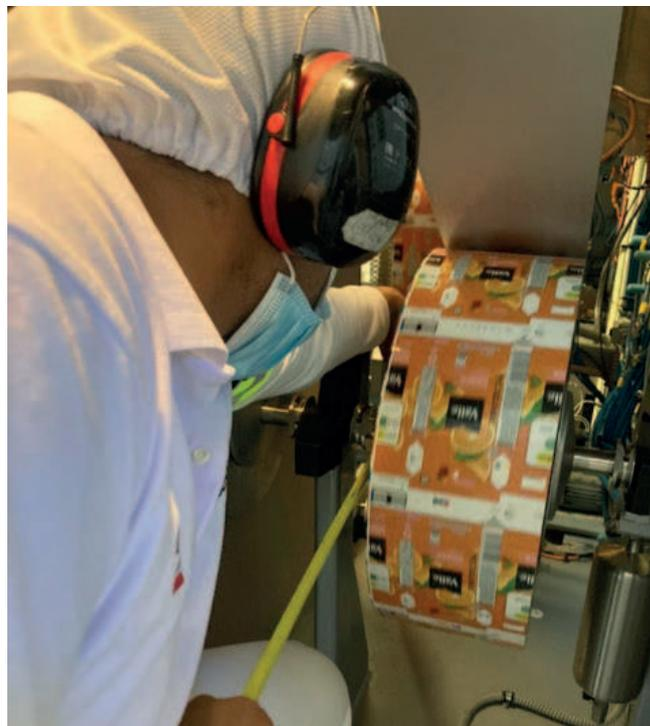
Nota. Se puede visualizar que al operario se le dificulta mucho la toma de la medida con el flexómetro.
